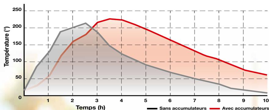
Température de l'air diffusé par l'appareil dans le temps avec ou sans accumulateurs.
